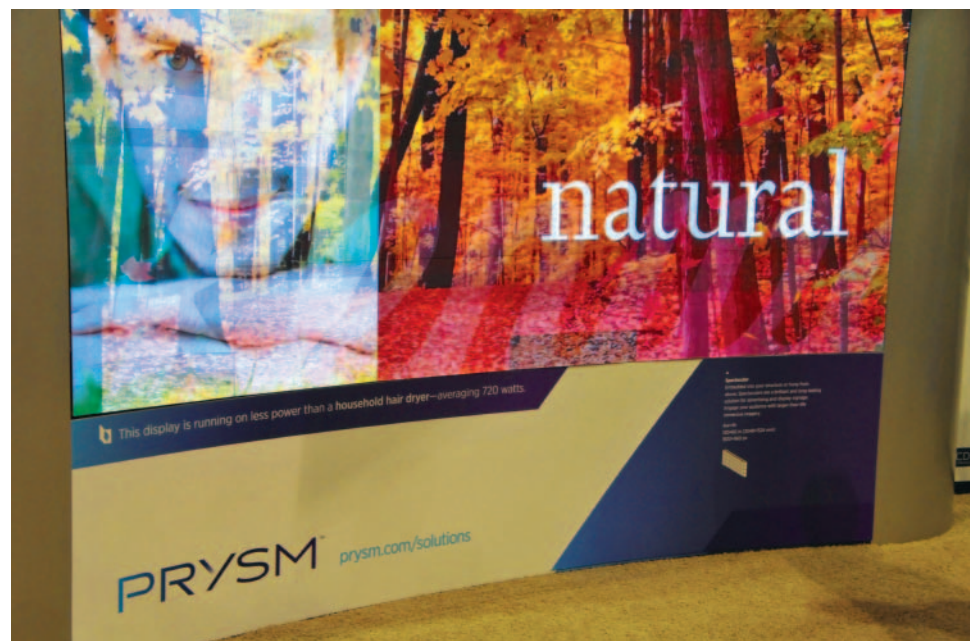
LPD-экран фирмы Prysm. Надпись под изображением гласит: «Этот дисплей потребляет меньше энергии, чем обычный бытовой фен – в среднем 720 Вт»
